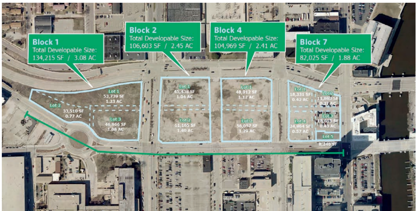
Quatre hectares ont été libérés par la démolition de la Park East Freeway dans sa section centrale, permettant de construire environ 100 000 m 2 de surface de plancher sur 4 îlots et une douzaine de lots. © Milwaukee County and City of Milwaukee
