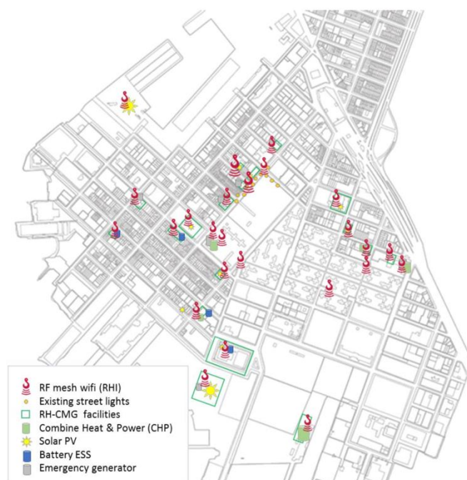
Figure 43. Les nœuds du réseau de la micro-grid =© Red Hook, NYSERDA.
