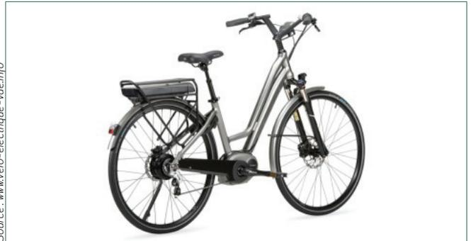
Le VAE dispose d'une batterie et d'une assistance électrique. Il est nécessaire de pédaler pour que l'assistance entre en action. Le VAE permet de parcourir des distances plus grandes et de franchir les pentes plus facilement.
