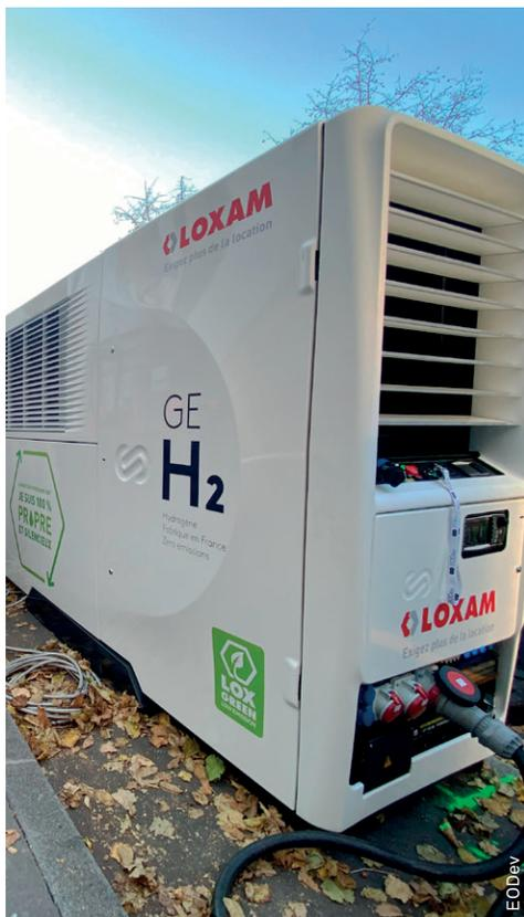
Utilisation du  $GE H_2$  d'EODev, groupe électrogène à hydrogène, pour un chantier CPCU avec Loxam et la ville de Paris.
