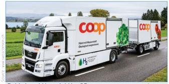
**Poids lourd Hyundai H<sub>2</sub>:** 35 tonnes, pouvant avoir une autonomie de près de 400 km. Hyundai est en train de développer des véhicules avec une autonomie de 1 000 km.
