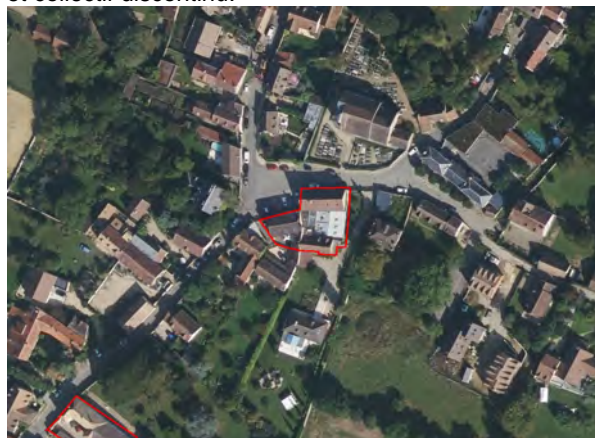
Bâti mixte traditionnel constitué de 6 logements en centre-bourg – commune de Magny-les-Hameaux – Emprise foncière : 734 m 2 ; COS = 0,89 ; CES : 0,84 ; densité résidentielle : 80 lgt/ha.
