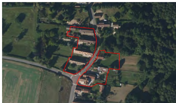
Habitat individuel villageois constitué de 7 anciennes fermes ou maisons rurales réhabilitées en maisons individuelles principales ou secondaires – Commune de Hermeray – Total des emprises foncières : 5 742 m 2 ; COS = 0,22 ; CES : 0,29 ; densité résidentielle : 12 lgt/ha.
