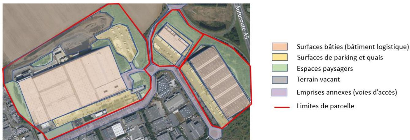
Le schéma ci-dessus, réalisé à partir d'une vue aérienne de la base Intermarché DAI n°1, n°3 et l'agence de messagerie DB Schenker du Vert-Saint-Denis (Seine-et-Marne) permet d'illustrer cette pluralité des espaces au sein d'un site logistique ainsi que la différence notable entre les surfaces logistiques à proprement parler et l'emprise foncière d'une parcelle logistique.
